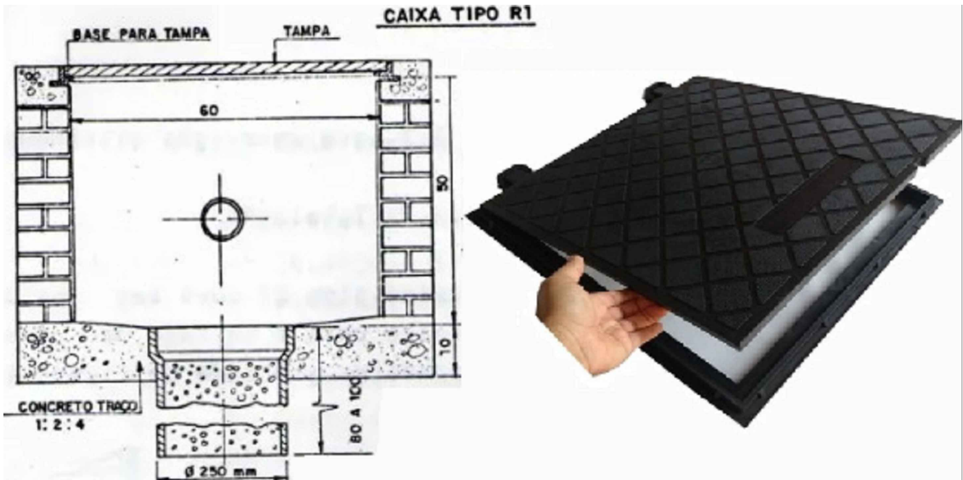
DETALHE 1: CAIXA DE PASSAGEM R1 40X60 COM TAMPA METÁLICA ARTICULADA
